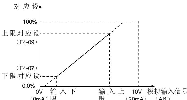
图 6-7 模拟输入上下限示意图
