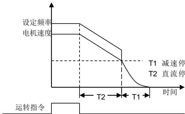
图 6-25 减速停车加直流制动
