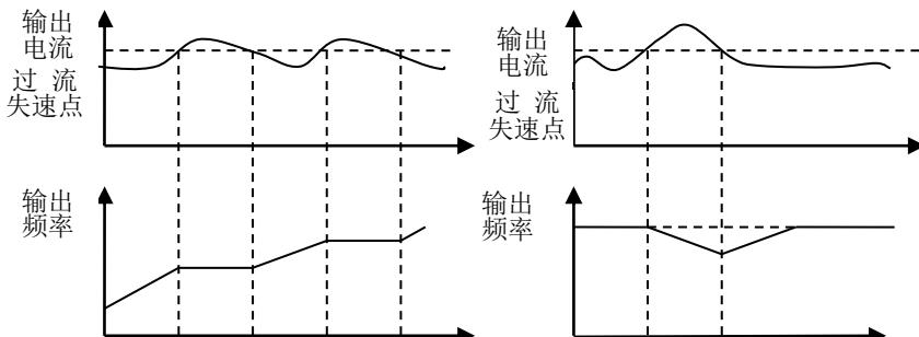
图 6-33 加速运行中过流失速控制
