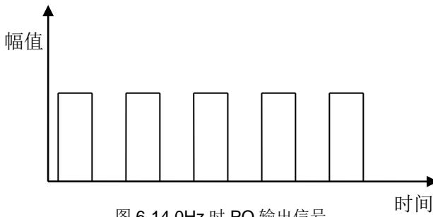
图 6-14 0Hz 时 PO 输出信号
