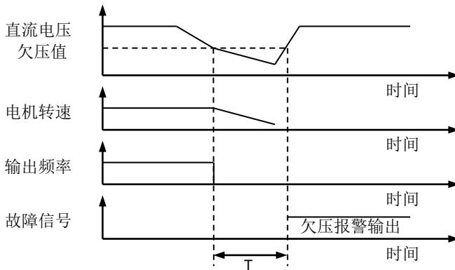
图 6-17 停电超时欠压保护  $T > F6-02$
