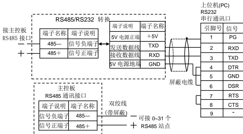
图 3-3 变频器串行通讯接口端子的接线
