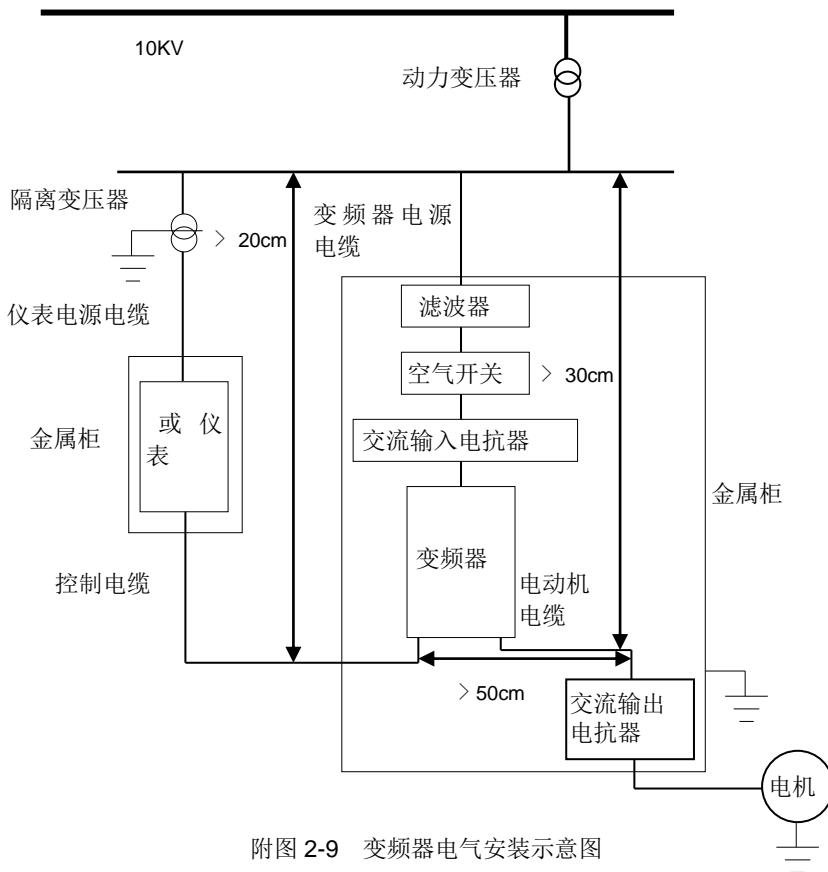
附图 2-9 变频器电气安装示意图
