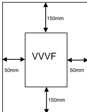
多台变频器安装在同一机柜里时，为减少相互热量影响，请横向安装。如必须上
