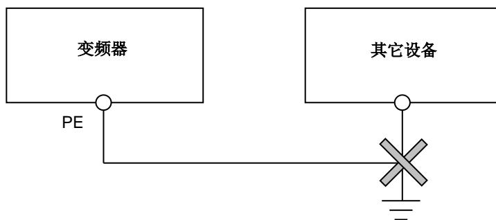
附图 2-5 共用接地线示意图（一）
