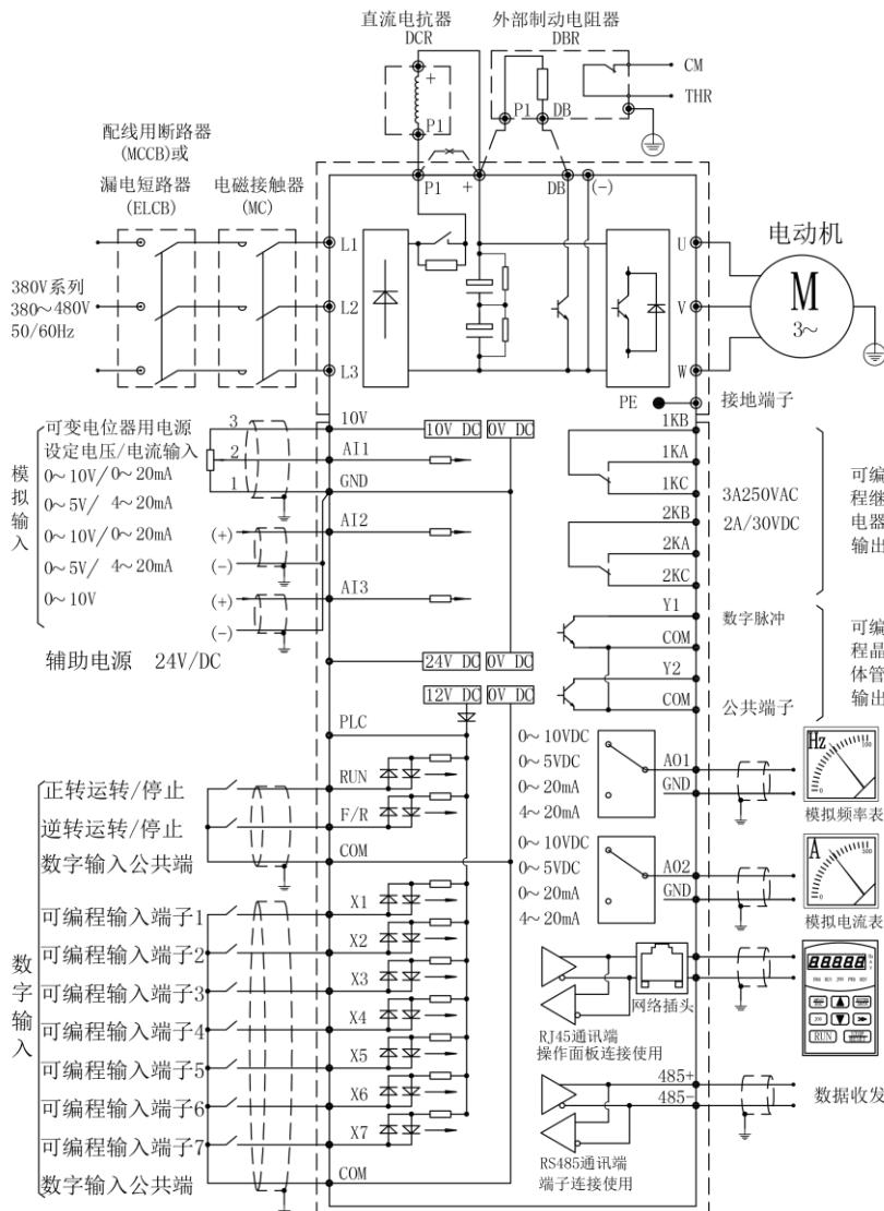
☆ 0.75kw-18.5kw 内置制动单元，使用时需把绝缘垫片取掉在 (+)、BR 之间连接制动电阻；
