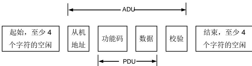
一个帧的信息必须以一个连续的数据流进行传输，如果整个帧传输结束前超过 1.5 个字节以上的间隔时间，接收设备将清除这些不完整的信息，并错误认为随后一个字节是新一帧的地址域部分，同样的，如果一个新帧的开始与前一个帧的间隔时间小于 4 个字节时间，接收设备将认为它是前一帧的继续，由于帧的错乱，最终 CRC 校验值不正确，导致通讯故障。
